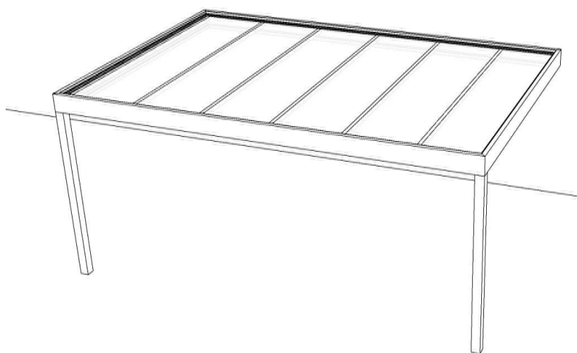
Standardní montáž 1-modulu se 2 sloupy
